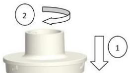
5) Fixer l'ensemble moteur **D** sur le couvercle d'entraînement **I** de manière à ce que le marquage de fixation "→ Lock" se trouve sous le symbole
