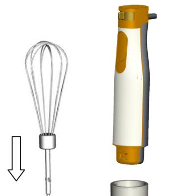
2) Fixez le boîtier du moteur **D** à la base du fouet **H de manière** à ce que le marquage de fixation "→ Lock" se trouve sous le symbole
